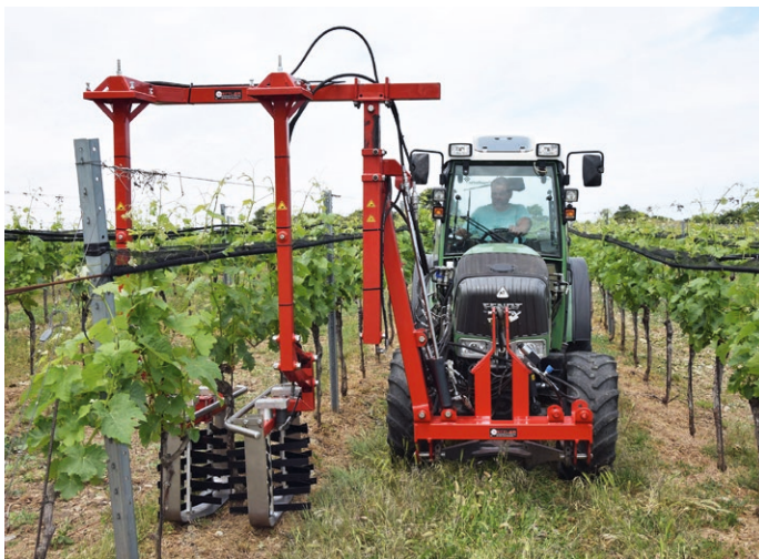
Beim Überzeilen-Stockputzer von Sattler entfernen vier Rotoren auch die bodennahen jungen Triebe. Foto: Sattler Weinbaugeräte
