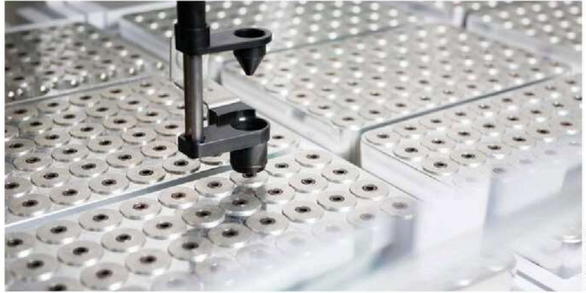
Dank der Analysetechnik namens »@ll tested« der Korkindustrie Trier können große Korkmengen auf TCA analysiert werden.
